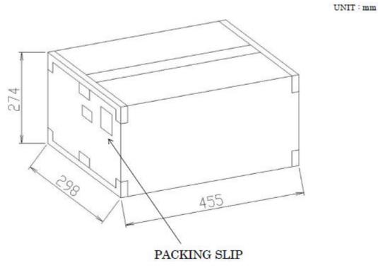
PUT MAX 8 BAGS IN THE CARTON BOX. AFTER PACKING BY TAPE (5,600 PCS MAX) PUT THE PACKING SLIP ON THE SIDE OF THE CARTON BOX.
